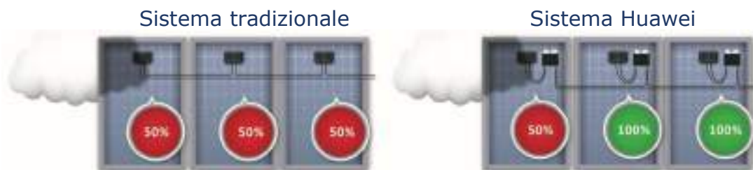
Confronto tra il rendimento di un impianto tradizionale ed uno ottimizzato in caso di ombreggiamento
